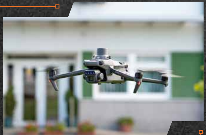
DJI Mavic 3 Multispectral felmérő drón ötvözi a négyosatomás multispektrális és a nagyfelbontású látható fényű (RGB) képalkotást. Fotó – AXIÁL Kft.
