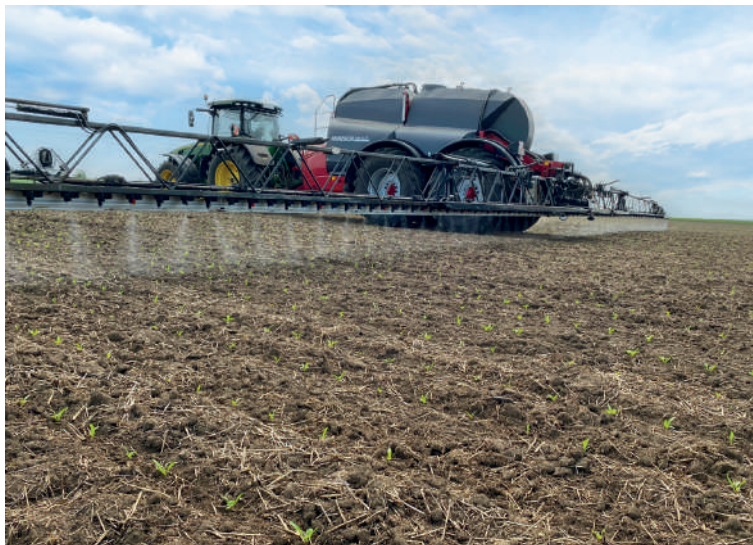
A gyomirtószeres kijuttatása sávos permetezésként, cukorrépában 45 cm-es sorszélességgel, HORSCH Leeb 12 TD-vel.
