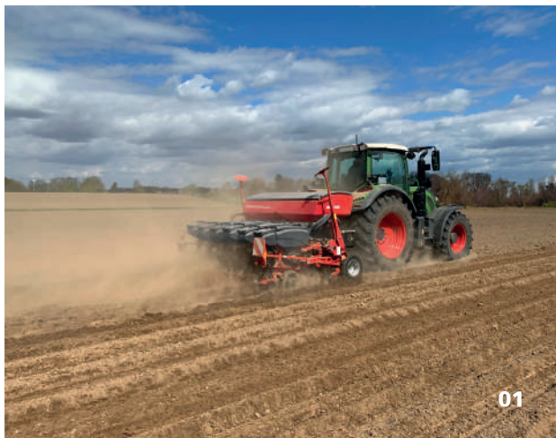
01 Maestro 6 TX kukorica vetése 50 cm-es sorszélességgel 02 Maestro 6 TX műtrágyázó berendezés nélkül
