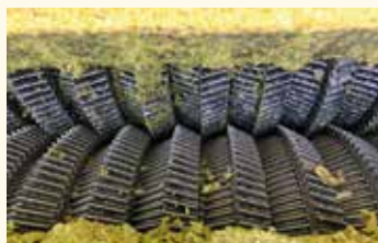
Az MMC MAX hengerprofilja egymásba futó gyűrű-szegmensekkel.
