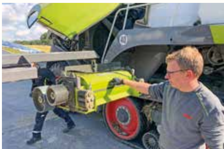
A JAGUAR TERRA TRAC silózó roppantó-szerkezetének oldalirányú cseréje.
